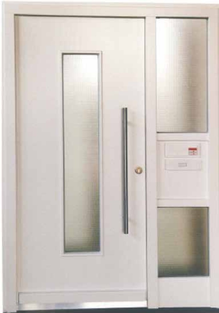
58 Holzart: Meranti Oberfläche: deckend weiß Beschlag: Edelstahl Glas: Orn. Mastercarre weiß
